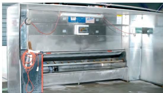
◀▲ La société Degami a fourni à Athis-Marbre un système de traitement et de recyclage des eaux sans floculant Eich et une cabine aspirante de 4 m de long Air Box fonctionnant par nébulisation d'eau.
