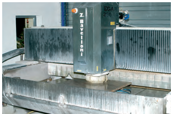
▲ Une débiteuse numérique TC 04 Thibaut/Calas a été installée à l'occasion du déménagement. Un lien informatique la relie désormais au centre de façonnage Egar Bavelloni livré en mai 2001.
