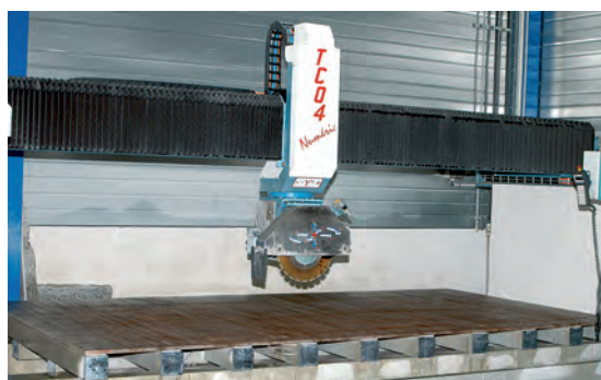
▲ Une débiteuse numérique TC 04 Thibaut/Calas a été installée à l'occasion du déménagement. Un lien informatique la relie désormais au centre de façonnage Egar Bavelloni livré en mai 2001.
